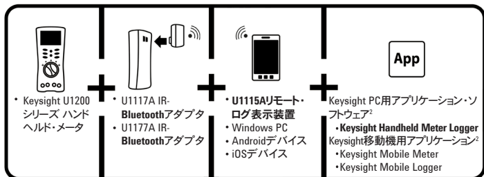
図1 Keysight無線リモート・コネクティビティ・ソリューション
